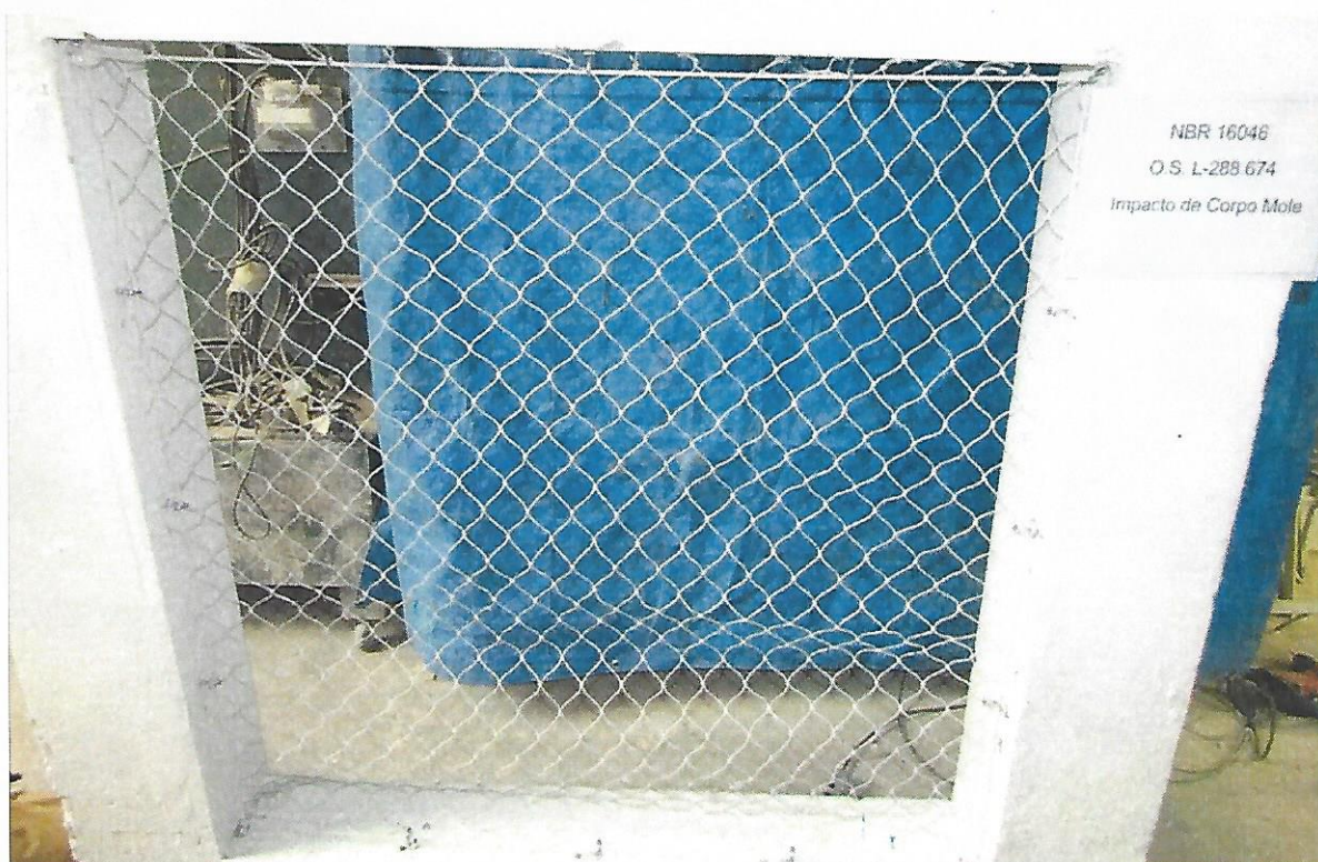
Foto n.º 01 – Visualização antes do ensaio de resistência ao impacto
