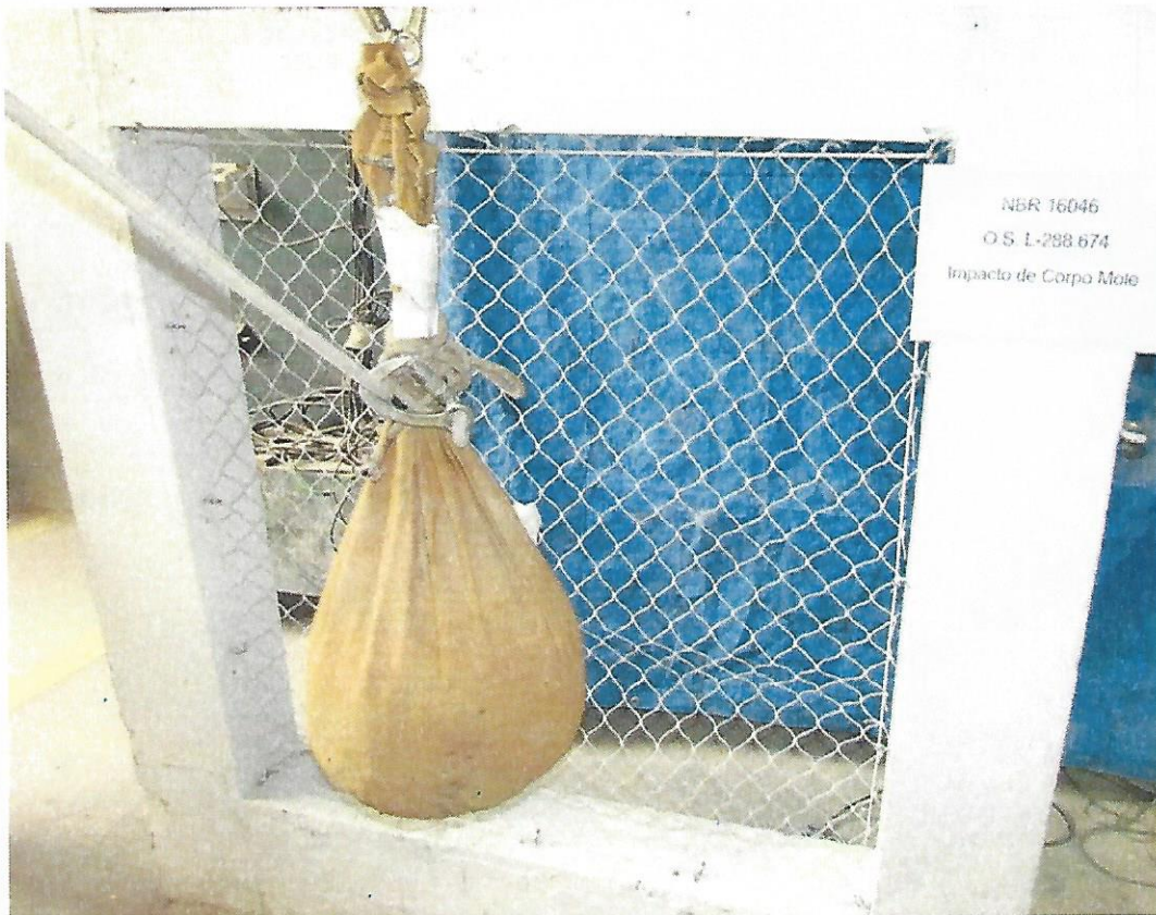
Foto n.º 02 – Visualização após o ensaio de resistência ao impacto de corpo mole
